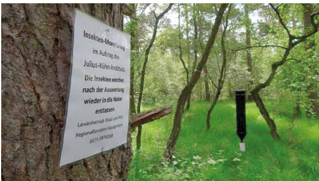
Abb. 7: Fangsystem für das Monitoring der Kiefernholz-nematode
