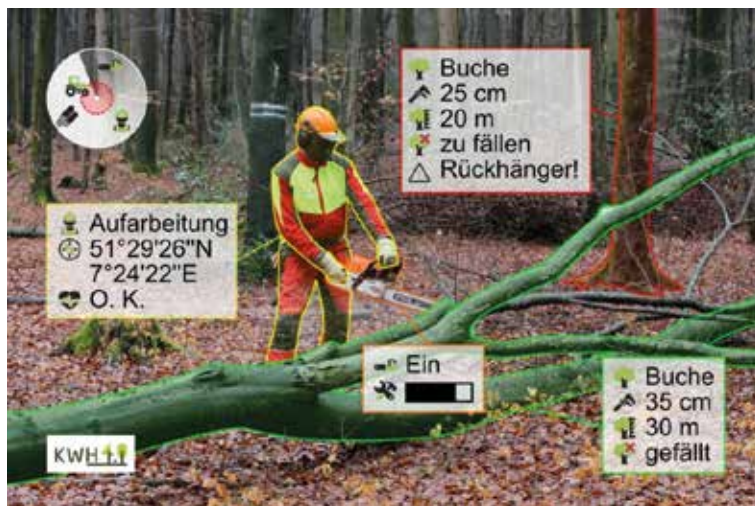
Abb. 4: Übersicht über den Status quo von praxisrelevanten und aktuell nutzbaren Informationen, die dem „Smart Forest Worker“ für die Waldarbeit der Zukunft bereits heute zur Verfügung stehen. Neben Informationen zu den zu fällenden Bäumen und deren besonderen Gefahren und bereits aufgearbeiteten Sortimenten wird über den Zustand seiner Arbeitsmittel oder ggf. seinen aktuellen Gesundheitszustand informiert (z. B. für die Pausengestaltung). Ferner werden Standorte anderer Personen oder Maschinen in seiner Nähe ermittelt. Quelle: KWH 4.0 2020
