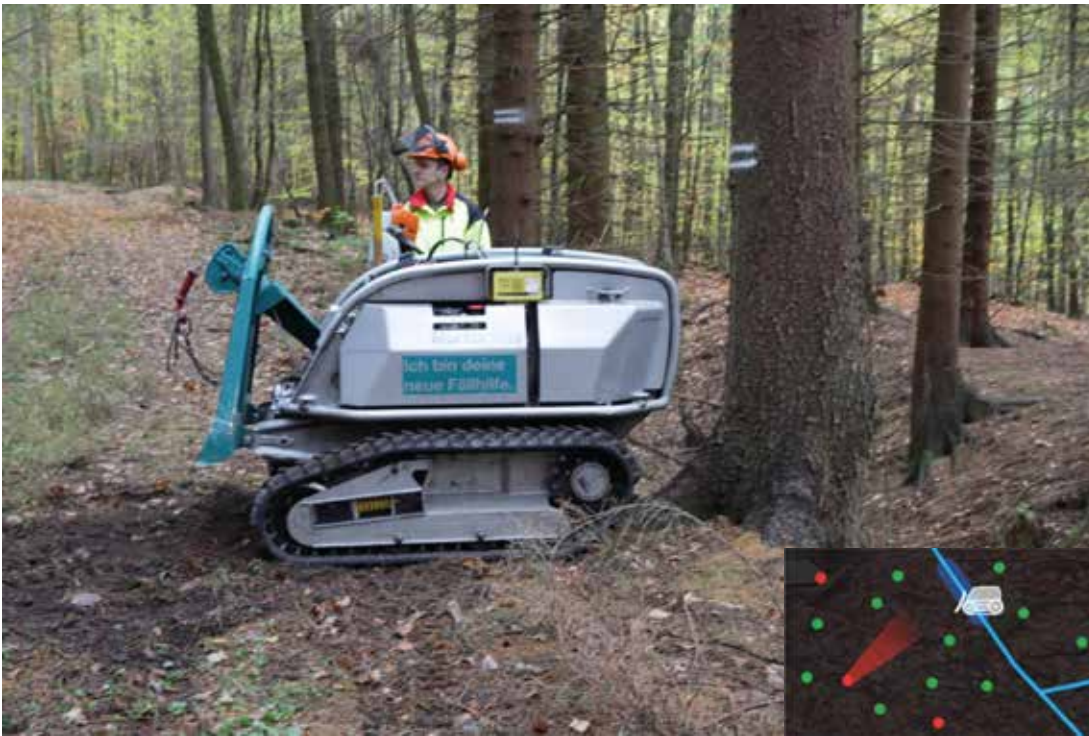
Abb. 6: Fällraupe Moritz Fr 50: Positionierungsvorschlag (blau) für Fällhilferaupe mit zu fallenden Bäumen (rot) und Fällrichtung (roter Trichter). Quelle: KWH 4.0
