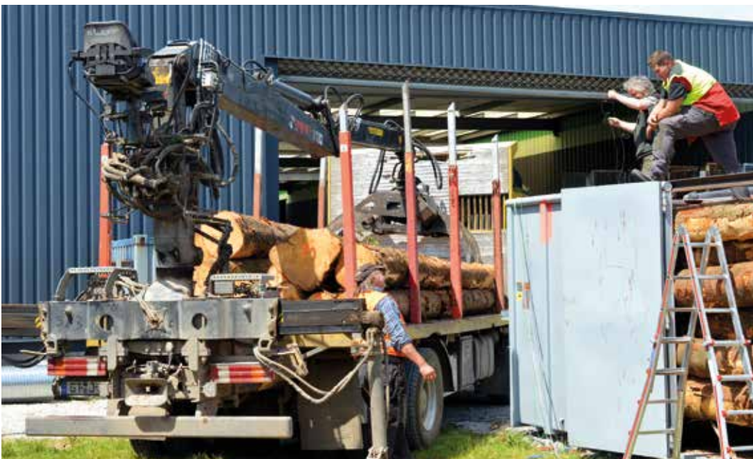
Abb. 1: Die Stammholzabschnitte werden in die mobile Hitzebehandlungskammer geladen
