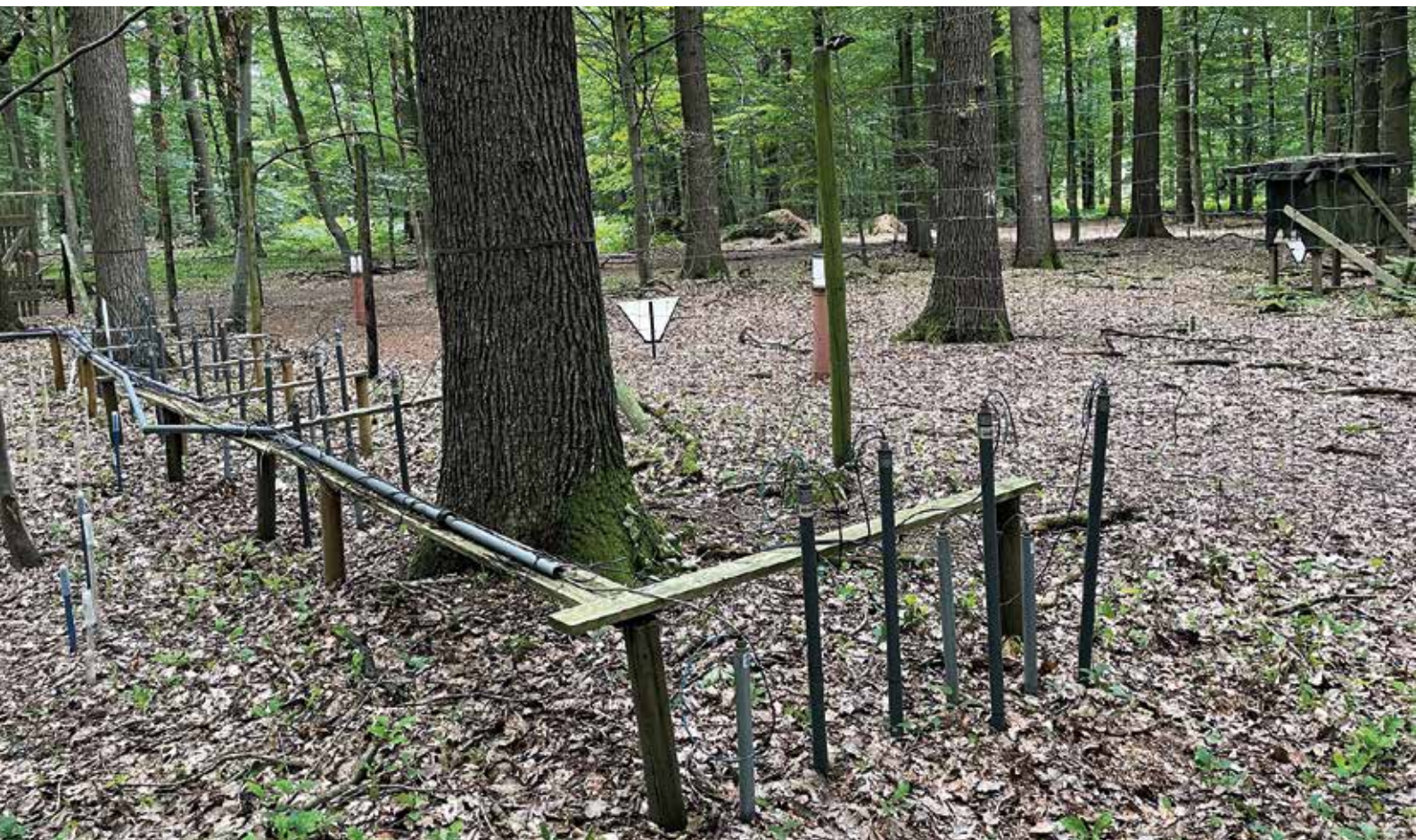
Messung der Bodenwasserspannung mit Tensiometern auf der Level-II-Fläche Kleve-Tannenbusch
