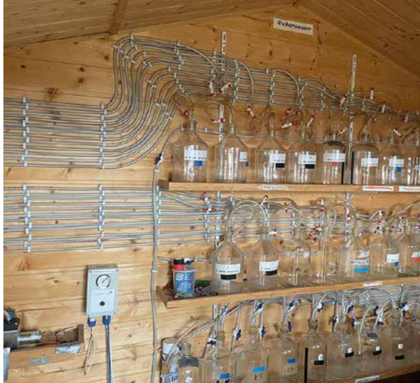
Sickerwasseranlage auf der Level-II-Kalamitätsfläche Elberndorf
