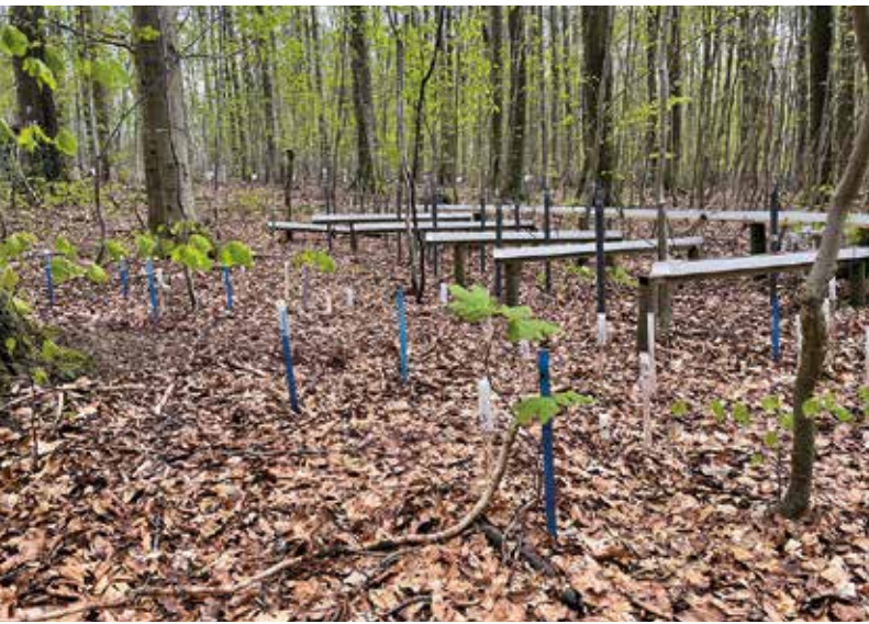
Messung der Bodenwasserspannung mit Tensiometern auf der Level-II-Fläche Schwaney
