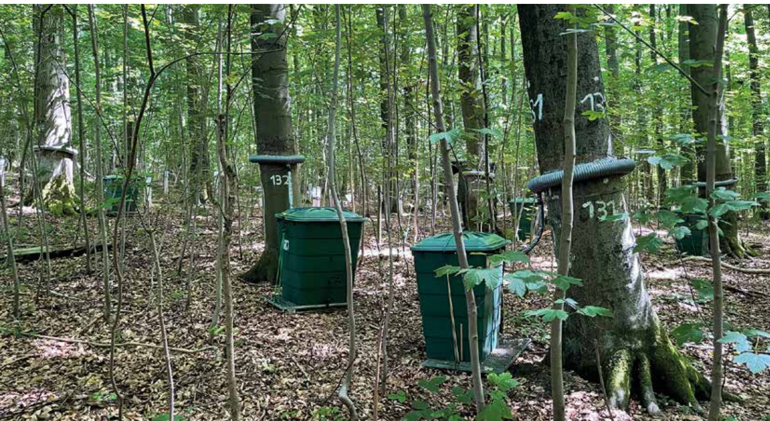
Stammabflussmessung auf der Level-II-Fläche Schwaney
