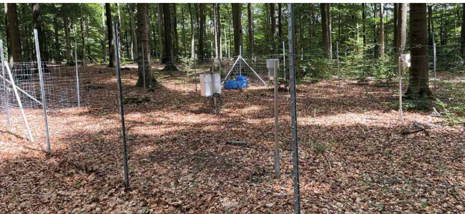
Bodenfeuchtemessstation auf der Level-II-Fläche Rott/Eifel
