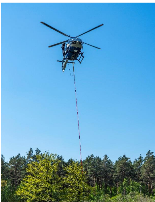
Abbildung 4: H 145 der PFSt NRW mit Bambi-Bucket an Longline (20m) [Foto: Jochen Tack/IM NRW]
