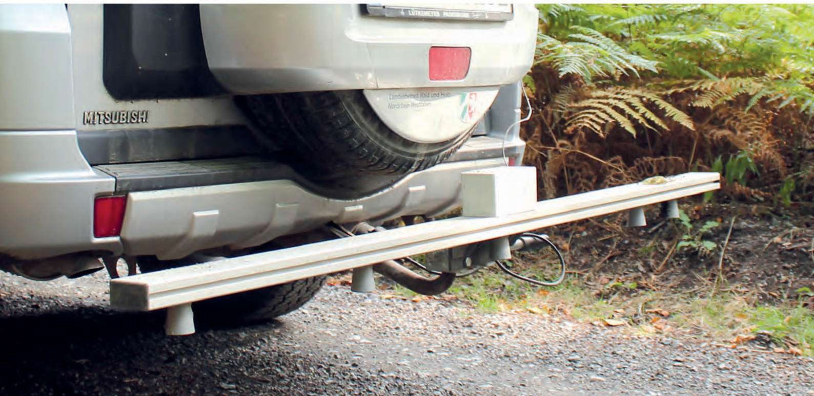
Abb. 1: Wegelanze, am PKW montiert, für eine automatische sensorbasierte Erfassung des Wegezustands
