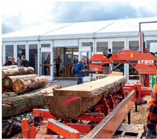
Abb. 5: Einschnitt von Buche, Birke, Eiche, Küstentanne und Douglasie im mobilen Sägewerk und Demo zu den Verwendungsmöglichkeiten dieser Baumarten im Bauwesen und im Bereich holzbasierter Materialien
