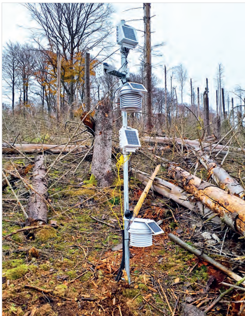
Abb. 1: Klimamessstation auf Fläche mit liegendem und stehendem Totholz im Arnsberger Wald
