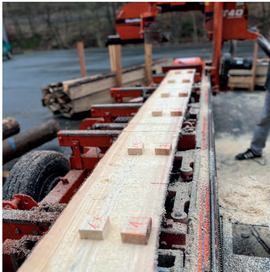
Abb. 5: Darstellung der Entnahme von Prüfkörpern aus Kern und Splint entlang eines Abschnitts (3,1 m) aus dem Trockenlager zur Feuchtemessung mittels Darrverfahren
