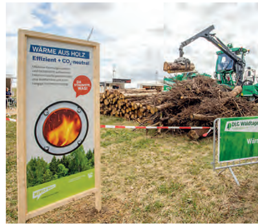
Abb. 6: Der zur Biomassefeuerung passende Brennstoff – Demo der Aufbereitung von unterschiedlichen Waldenergieholzsortimenten und Einfluss des Ausgangsmaterials auf Hackschnitzelqualität und Brennstoffparameter
