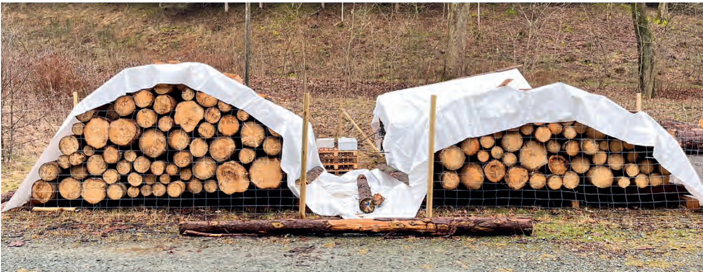
Abb. 3: Kalamitätsholz-Trockenlager (relative Holzfeuchte ca. 30 %) mit starken Unterlegern und Plane abgedeckt, separiert nach Befallsstadien (0/6/12 Monate) und ausgestattet mit Holzfeuchtesensoren zur Aufzeichnung der Holzfeuchte über einen Zeitraum von zwei Jahren
