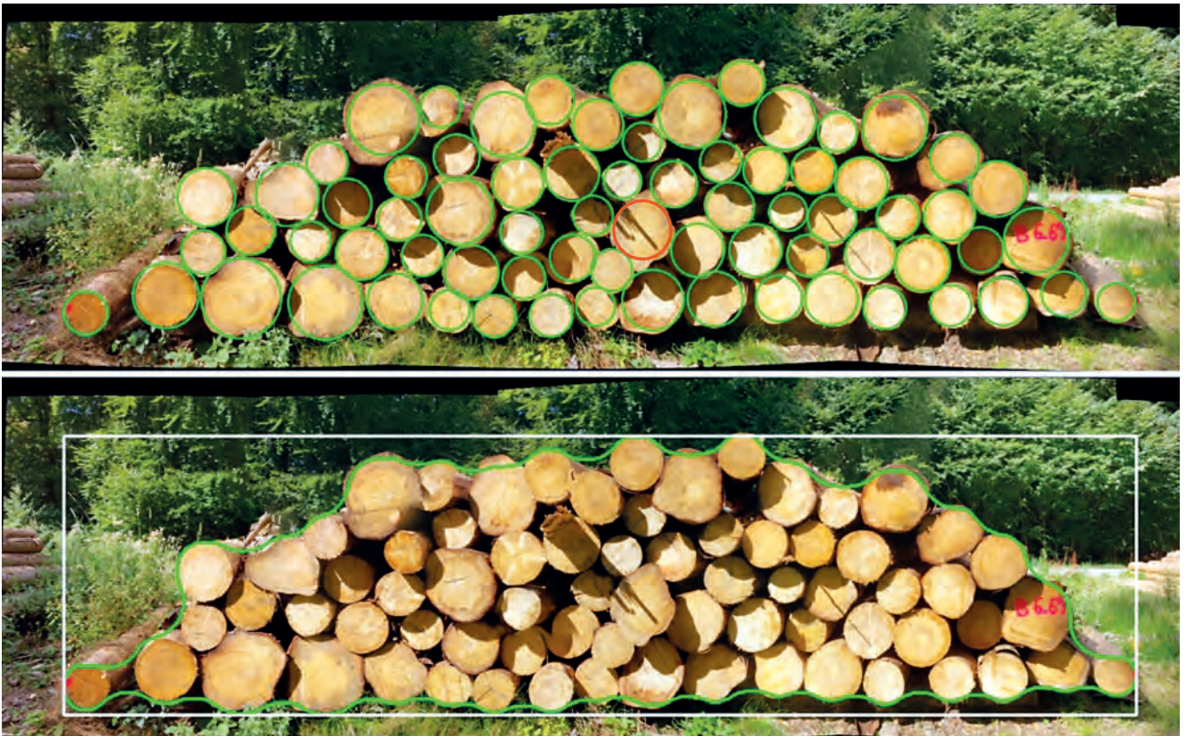
Abb. 4: Mit der Anwendung iFOVEA Pro aufgenommenes Stammholzpolter. Auf dem aus Einzelfotos zusammengesetzten Bild sind oben die erkannten Einzelstämme markiert, unten ist die angepasste Kontur der Polterstirnfläche sowie deren minimal umgebendes Rechteck eingezeichnet. Im oberen Bildteil ist ein Stamm gekennzeichnet, dessen Stirnfläche von der Anwendung nicht erkannt wurde (orangefarbener Kreis).
